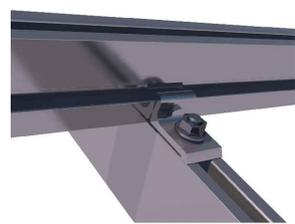
Detalle fijación G1 a triángulo
